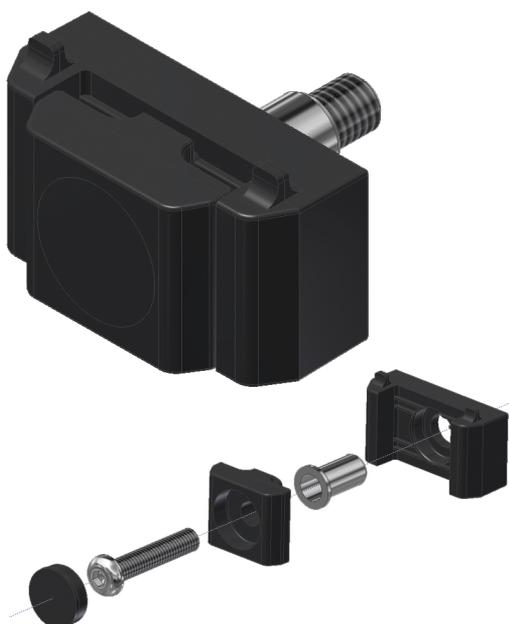
Eck-Montagegriff mit Kunststoff-Pressplatte wird an allen Eckpfosten montiert. Typ 3D fuer Draht Ø 4,5,6 und 2D 6/5/6 i 8/6/8. Er wird auch fuer die Pfosten verwendet, die breiter als 40 mm sind. Er wird bei den Industrie- und Sportzaeunen, oeffentlichen Zaeunen sowie Privateigentuemern verwendet
